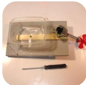
8. Вставляем батарейки в батарейный отсек и проверяем работоспособность мотора. Провода мотора продеваем через отверстия в крышке, так как батарейка будет внутри пластиковой коробки. Запоминаем подключение «+» и «-» к мотору, чтобы он гнал воздух от себя назад.
