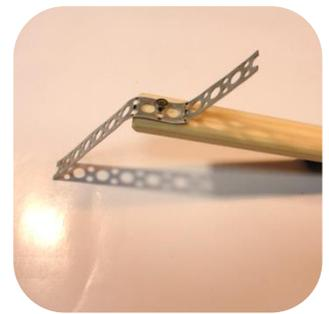
3. Прикрепляем клипсу к крепежной ленте через маленькое отверстие. Вставляем в клипсу электромотор.
